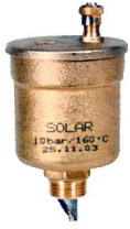
Fig. 15 bis. Purgador apto para energía solar. Lleva un flotador de resina capaz de soportar 160 °C, y su presión máxima de trabajo es de 12 bares. (Cortesía de Watts Industries).
